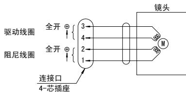
注：视频光圈信号不适用于本镜头。请使用能提供直流光圈信号的摄像机。
